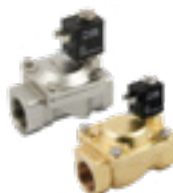
Elettrovalvole 2 vie servoassistite, membrana, corpo ottone o inox.
