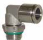
Raccords instantanés en acier AISI 316, tubes du Ø 4 au 12 mm, filetages du M5 au 1/2".
