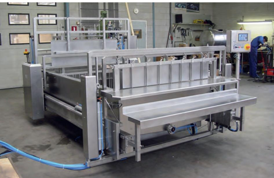
In een draineerbak verzorgen de verschillende pneumatische cilinders voor pers-, snij-, duw- en liftbewegingen
