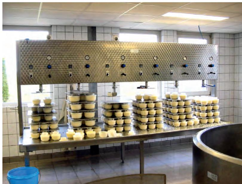
In deze kaaspersen van C. van 't Riet worden de kazen in de vormen onder druk gehouden met speciale pneumatische cilinders
