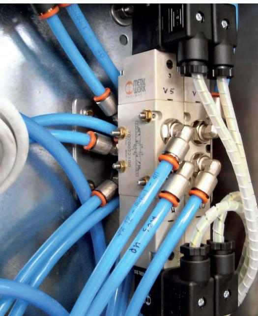
Deze 5/3-ventielen krijgen de signalen van een centrale PLC en zorgen voor de verdere aansturing van de cilinders
